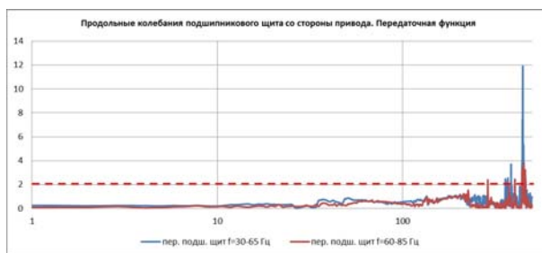
Рис. 9 Колебания ПЩ со стороны привода. Передаточная функция
